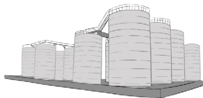
大型勾兑（正式勾兑）一般采用大型不锈钢酒罐。
